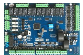
Protection function PCB board 保护功能控制板
